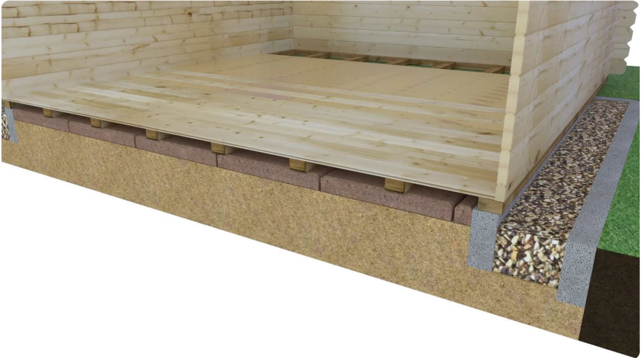
Zandbed met bestrating en opsluitbanden — vlak en waterpas.
